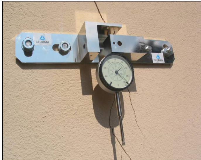
شکل ۵-۱۰ ترک‌سنج دو بعدی با گیج قرائت عقربه‌ای
