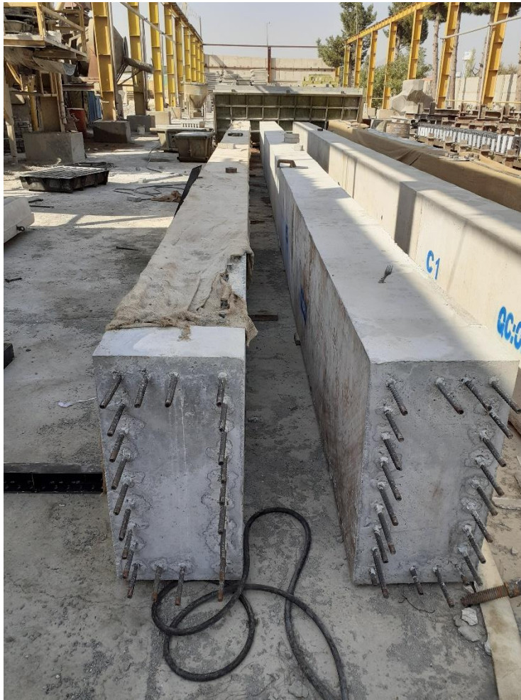
شکل ۳-۳۳ ستون‌های پیش‌ساخته بتنی آماده شده در کارخانه برای حمل به محل پروژه
