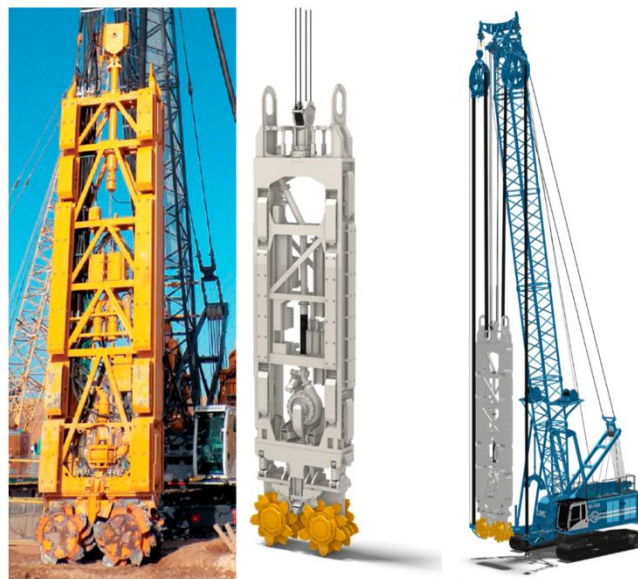
شکل ۳-۴ اجزاء حفاری هیدرومیل که از یک دستگاه جرثقیل معلق است.
