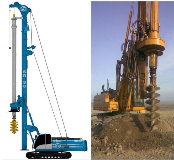
شکل ۳-۲ یک نمونه دستگاه حفار روتاری (دورانی) شمع.
