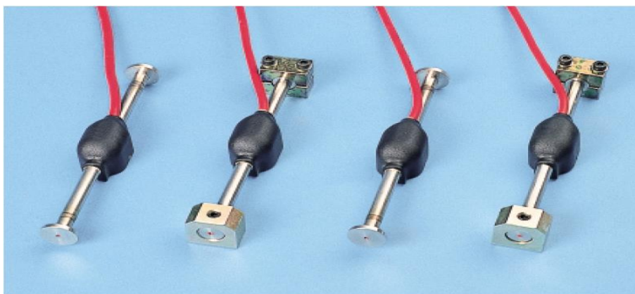
شکل ۵-۱۲ نمونه‌ای از کرنش‌سنج‌های مدفون در بتن مورد استفاده در پایش‌های ژئوتکنیکی
